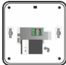
3. Установите аккумулятор обратно, совместив контакты на аккумуляторе с клеммой на плате, и закройте отсек.
